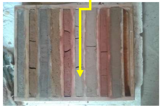
شكل رقم (40) صورة لانواع الطين و اختيار الطين المناسب
