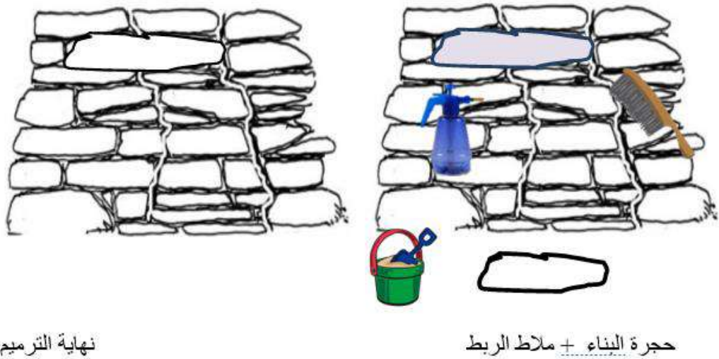
شكل رقم (34) مراحل الترميم
