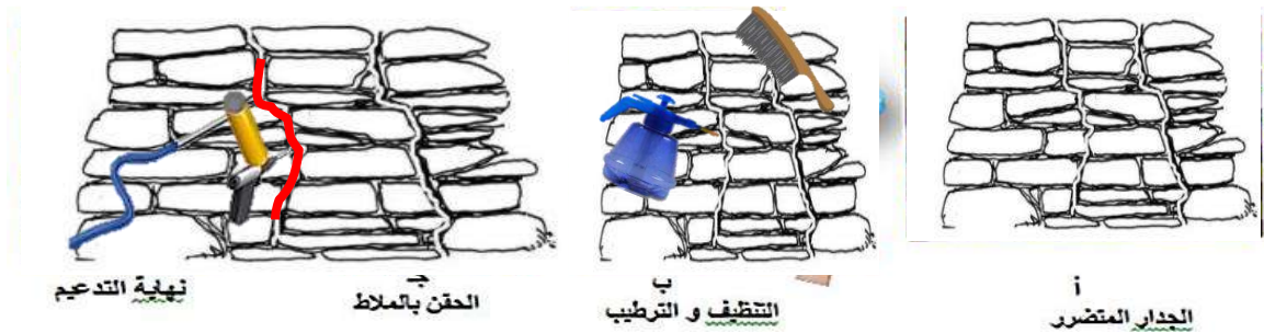
شكل (33) التدعيم عن طريق الحقن بملاط سائل
