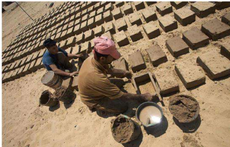
شكل رقم (20) صناعة الطوب
